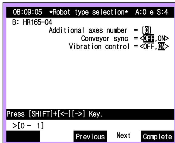
Also, after the initialization is completed, go to 『[PF2]: Service』 → 『7: System checking』 → 『1: System Version』 → 『[PF4]: Next』 to check vibration controller availability.
